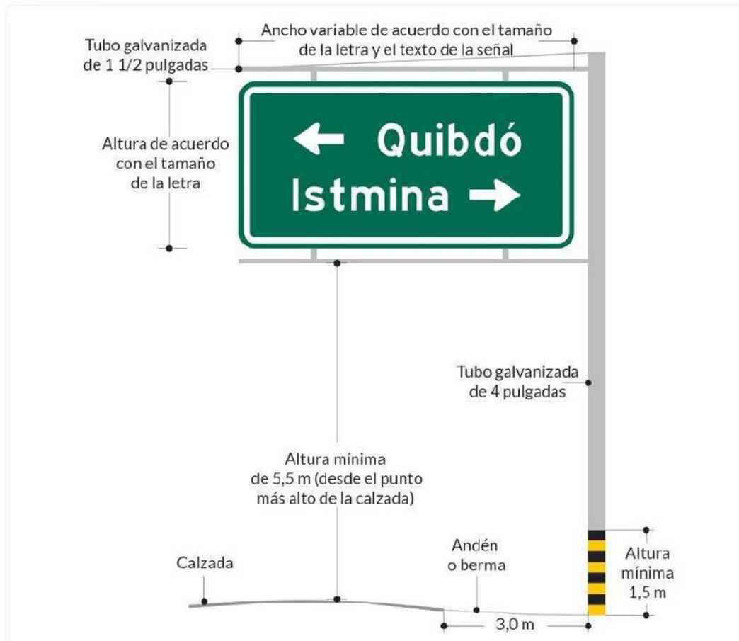
**Nota 1:** La recomendación dada podrán utilizarse para tableros de señales de hasta 3,00 metros cuadrados de área. Para dimensiones mayores deberá surtirse el proceso de aprobación del diseño estructural correspondiente.
