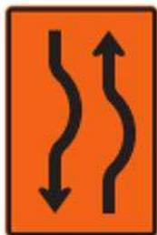
**SIO – 21 Cambio de alineamiento al lado derecho en una calzada bidireccional de dos carriles**
