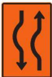
**SIO – 22 Cambio de alineamiento al lado izquierdo en una calzada bidireccional de dos carriles**
