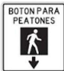
Esta señal se emplea para reforzar la seguridad vial de los usuarios de las vías y en especial a los peatones, indicando en intersecciones semaforizadas, el sitio mismo donde se encuentra el sistema de activación por demanda de peatones mediante un "PUSH BUTTON". Se recomienda su instalación en el soporte del semáforo.
