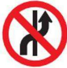
Esta señal se emplea para notificar al conductor la prohibición de cambiar la calzada por la cual está circulando; se usará en vías con separador central y un solo sentido de circulación, en donde resulte peligrosa la maniobra del cambio de calzada
