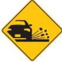
Esta señal se emplea para advertir a los usuarios la posible presencia de grava o material suelto que puede ser levantado y lanzado por los vehículos, dañando a terceros. La presencia de esta señal no es excusa para no mantener limpia la vía.
