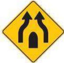
Esta señal se emplea para advertir a los usuarios que circulan por una vía con tránsito en un sentido y con separador central, la próxima terminación del separador, conservándose la circulación en un sentido.
