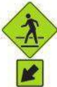
Esta señal se debe emplear para indicar a los usuarios, el sitio mismo de ubicación de un cruce peatonal. A criterio del diseñador del proyecto de señalización, según el riesgo, podrá complementarse con la señal reglamentaria Velocidad Máxima SR-30.
