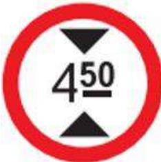
Esta señal se emplea para notificar a los conductores la altura máxima total permitida a los vehículos con su carga, para la circulación segura por la vía. Debe expresarse en metros y aproximarse a la décima inferior; por ejemplo 4,55 m, se indica en la señal 4,50 m. Debe ser complementada con la señal SP-50 –ALTURA LIBRE (X-xx)– y ser concordante con la dimensión expresada en ésta. Cuando la altura libre sea menor a 4,30 m, siempre debe instalarse la señal.
