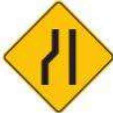
Estas señales deben ser usadas para advertir a los usuarios sobre la proximidad de una reducción del ancho de la calzada con desplazamiento del eje a la derecha. Esta reducción puede ser del número de carriles o, simplemente de las dimensiones de la calzada.
