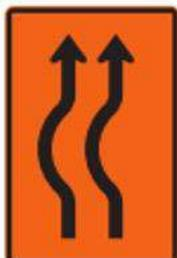
**SIO-19 Cambio de alineamiento al lado izquierdo en una calzada unidireccional de dos carriles**
