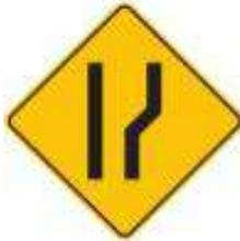
Esta señal se utiliza para advertir a los usuarios sobre la proximidad de una ampliación transversal de la calzada al costado derecho. Esta ampliación puede ser del número de carriles o simplemente de las dimensiones de la calzada.
