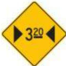
Esta señal se usa para advertir a los usuarios que más adelante en la vía existe una restricción de ancho que restringe a ciertos vehículos. La cifra anotada debe aproximarse a la décima inferior; por ejemplo 3,28, se indica en la señal 3,20. La señal debe indicar el ancho máximo que permite la restricción, debiendo ser instalada de acuerdo con lo señalado en el numeral 2.3.3. Ubicación de las Señales Preventivas.
