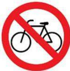
Esta señal se usa para prohibir la circulación de bicicletas y motocicletas. Se debe instalar en vías donde sea probable la presencia de ciclistas y el tránsito de vehículos motorizados haga riesgosa su circulación. Se debe instalar siempre en los accesos a autopistas, troncales, arterias y túneles. Se podrá complementar con leyendas en una señal rectangular o una placa adosada que indique la zona o infraestructura donde aplica la restricción, como por ejemplo “EN TÚNEL”
