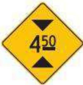
Esta señal se usa para advertir a los usuarios que más adelante en la vía existe una restricción de altura en un túnel, puente, paso a desnivel, u otros. La cifra anotada debe aproximarse a la décima inferior; por ejemplo 4,55, se indica en la señal 4,50. La señal debe indicar la altura máxima permitida y ser instalada de acuerdo con lo señalado en el numeral 2.3.3. Ubicación de las Señales Preventivas.
