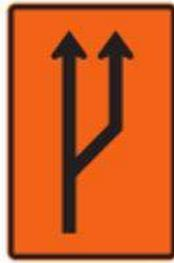
**SIO-13 Generación de carril derecho en una calzada unidireccional de un carril**
