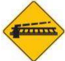
Esta señal se debe utilizar para advertir a los usuarios la proximidad de un cruce ferroviario a nivel en operación, provisto de barreras accionadas manualmente o en forma automática.
