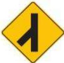
Esta señal se utiliza cuando es necesario advertir a los usuarios sobre la proximidad a una intersección con incorporación de vehículos por la izquierda. La diagramación del símbolo debe representar la geometría actual. Sin embargo, no es necesario mostrar ángulos precisos; a modo de ejemplo,
