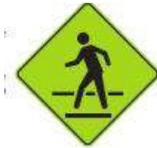
Esta señal advierte a todos los usuarios, la proximidad de un lugar con frecuente cruce de peatones. Esta señal no debe ser usada cuando el cruce peatonal forma parte de una intersección vehicular semaforizada. A criterio del diseñador del proyecto de señalización, según el riesgo, podrá complementarse con la señal reglamentaria Velocidad Máxima SR-30.
