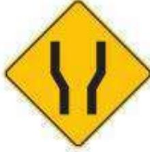
Esta señal se utiliza para advertir a los usuarios sobre la proximidad de una ampliación transversal de la calzada a ambos lados, conservándose el eje. Esta ampliación puede ser del número de carriles o simplemente de las dimensiones de la calzada.
