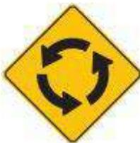
Esta señal debe ser instalada para advertir a los usuarios la proximidad de una glorieta, complementada con la demarcación respectiva; lo que requiere reducir la velocidad y ceder el paso al ingresar a la misma, en especial a usuarios vulnerables.
