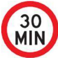
Esta señal se emplea para notificar a los conductores la velocidad mínima a la que se puede circular expresada en múltiplos de 10 y en km/h, con el fin de impedir que se conduzca un vehículo a una velocidad tan baja que entorpezca el desplazamiento del resto de los vehículos, lo que genera condiciones de riesgo. Su uso se restringe a autopistas, vías multicarril, túneles y puentes.
