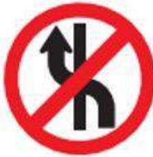
Esta señal se emplea para notificar al conductor la prohibición de cambiar la calzada por la cual está circulando; se usará en vías con separador central y un solo sentido de circulación, en donde resulte peligrosa la maniobra del cambio de calzada.
