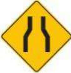
Esta señal debe ser usada para advertir a los usuarios la proximidad a una reducción o un estrechamiento de la calzada a ambos lados conservando el mismo eje. La reducción puede ser del número de carriles o simplemente del ancho de la calzada; y, no necesariamente debe ser igual en ambos lados.
