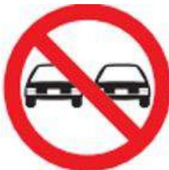
Esta señal se utiliza para indicar al conductor la prohibición de efectuar la maniobra de adelantamiento, mediante la cual un vehículo se sitúa delante de otro u otros que le anteceden traspasando el eje de la calzada.
