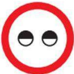
Esta señal se emplea para notificar al conductor la obligación de circular con las luces bajas del vehículo. Debe ubicarse, en entrada a túneles y pasos urbanos con iluminación artificial y, en vías rurales de terreno plano donde se puede encandilar al conductor que transita en sentido contrario. La no colocación de esta señal no implica la autorización del uso de las luces altas de los vehículos.
