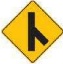
Esta señal se utiliza cuando es necesario advertir a los usuarios sobre la proximidad a una intersección con incorporación de vehículos por la derecha. La diagramación del símbolo debe representar la geometría actual. Sin embargo, no es necesario mostrar ángulos precisos; a modo de ejemplo, flujos que convergen a 20° y 35° pueden representarse de la misma manera.
