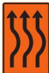
**SIO – 18 Cambio de alineamiento al lado derecho en una calzada unidireccional de tres carriles**
