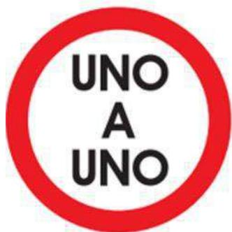
El control con este tipo de señal vertical, se debe aplicar durante el día, cuando el volumen de tránsito sea muy bajo, de tal manera, que se garantice ante todo la visibilidad y la seguridad de todos los usuarios y según lo definido en el numeral 4.6.6. Señales Reglamentarias. Si se habilita en la noche, debe acompañarse de una lámpara intermitente. La zona de tránsito alternado en dos sentidos, debe ser menor a 30 m de tal manera, que no dé lugar a problemas operacionales.
