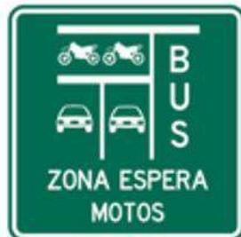
Esta señal se emplea para informar en una intersección semaforizada que cuenta con un carril exclusivo para otros medios de transporte como buses, la existencia de una zona de detención y espera, exclusiva y adelantada para motociclistas, en la cual, por seguridad vial ante la existencia del carril exclusivo, está prohibido el giro a la derecha.
