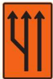
**SIO – 16 Generación de carril izquierdo en una calzada unidireccional de dos carriles**
