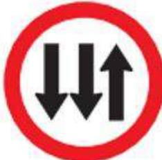
Esta señal se emplea para indicar el inicio de un tramo de tres carriles, en vías sin separador central, operando dos de los carriles en contraflujo. Esta señal debe complementarse con la señal SP-43 TRES CARRILES DE TRÁNSITO, DOS EN CONTRAFLUJO.
