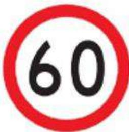
Esta señal se utiliza para indicar la velocidad máxima a la que pueden circular los vehículos a partir del lugar donde esté instalada. Debe ser repetida con un espaciamiento entre dos y cinco km de no haber un cambio de velocidad.
