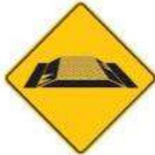
Esta señal se emplea para advertir a los usuarios la proximidad de un reductor de velocidad trapezoidal conocido como pompeyano, instalado como una medida de pacificación o tránsito calmado, en pro de la seguridad vial de los usuarios de la movilidad activa. Ver Figura 2-29 Señalización para reductor trapezoidal/pompeyano
