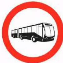
Esta señal se emplea para notificar a los conductores la exclusividad en la circulación para vehículos de transporte masivo, en el tramo siguiente a la señal. El pictograma podrá variar para indicar el tipo de transporte masivo, BRT o tranvía, al cual aplica la preferencia.
