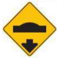
Esta señal se emplea para indicar a los usuarios, el sitio específico de ubicación de un reductor de velocidad.
