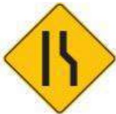
Estas señales deben ser usadas para advertir a los usuarios, la proximidad de una reducción del ancho de la calzada con desplazamiento del eje a la izquierda. Esta reducción puede ser del número de carriles o simplemente de las dimensiones de la calzada.
