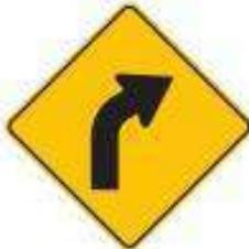
Estas señales se deben instalar para advertir a los usuarios la proximidad de una curva a la derecha, cuya velocidad de diseño es menor que la velocidad máxima permitida o de operación del resto de la vía. También se deben usar cuando la velocidad de diseño es igual a la velocidad máxima permitida o de operación de la vía, pero existen limitaciones de visibilidad u otras complicaciones operacionales.
