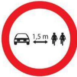
Esta señal se emplea para indicar a los conductores, la distancia mínima lateral de seguridad a la que deben circular los vehículos motorizados de los ciclistas. Se debe instalar en lugares respecto de los cuales estudios de tránsito demuestren la presencia frecuente de estos usuarios, en las vías de uso compartido.
