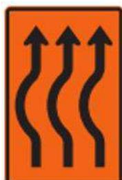
**SIO-20 Cambio de alineamiento al lado izquierdo en una calzada unidireccional de tres carriles**
