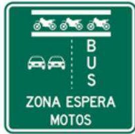
Esta señal se emplea para informar en una intersección semaforizada que cuenta con un carril exclusivo para otros medios de transporte como buses, la existencia de una zona de detención y espera, exclusiva y adelantada para motociclistas, en la cual, se tiene regulado y permitido el giro a la derecha.
