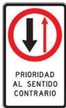
Esta señal se utiliza para indicar a los conductores que los vehículos que circulan en sentido opuesto tienen prioridad. Se instala en puentes vehiculares estrechos y angostamientos de calzada, entre otros lugares. Debe complementarse el mensaje en una señal con leyenda “PRIORIDAD AL SENTIDO CONTRARIO”. En vías en terreno montañoso con calzadas angostas se puede usar con la leyenda “PRIORIDAD AL TRÁNSITO QUE SUBE”, para asignar el derecho preferente de vía a los vehículos que suben.
