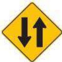
Esta señal advierte a los usuarios que circulan por una vía unidireccional, que se aproximan a un tramo de vía sin separador central, en el cual la circulación se efectúa en los dos sentidos. En ciertos casos, por ejemplo, en vías con altos volúmenes de tránsito o de visibilidad reducida, puede ser conveniente colocar también esta señal antes del punto determinado según lo indicado en el numeral 2.3.3. Ubicación de las Señales Preventivas.
