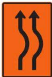
**SIO – 17 Cambio de alineamiento al lado derecho en una calzada unidireccional de dos carriles**
