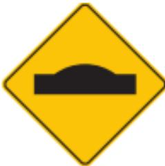
Esta señal se emplea para advertir a los usuarios la proximidad de un resalto en la superficie de la calzada, instalado con el propósito de controlar velocidades excesivas en la vía. Ver Figura 2-28 Señalización para resalto.
