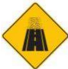
Esta señal se emplea para advertir a los usuarios que próximamente termina el tramo pavimentado, y se inicia una vía sin pavimento.
