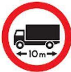
Esta señal se emplea para notificar a los conductores la longitud máxima total permitida para los vehículos con su carga, expresada en metros. Esta dimensión debe corresponder al 90% del espacio requerido por el vehículo tipo para el cual se diseñan los radios de giro. Esta señal debe ser complementada con la señal preventiva SP-76 –LONGITUD MÁXIMA PERMITIDA (X-xx)– y ser concordante con la dimensión allí expresada.
