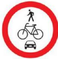
Esta señal se emplea para notificar a los conductores de vehículos motorizados la prioridad del ciclista en esa infraestructura. Debe ser empleada en toda aquella cicloinfraestructura compartida con vehículos motorizados. Puede estar acompañada de una placa adosada en la parte inferior con la leyenda "PRIORIDAD CICLISTA".
