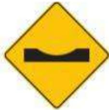
Debe complementarse con la señal reglamentaria Velocidad Máxima SR-30, para disminuir gradualmente la velocidad de operación en la medida en que los usuarios se van acercando a la depresión.
