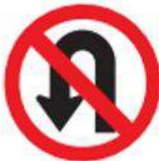
Esta señal indica al conductor que no puede girar en "U" o realizar el retorno. Se emplea cuando, el giro en "U" puede ocasionar entorpecimiento a los flujos de tránsito, el radio de giro sea pequeño o, la maniobra constituya un factor de riesgo.
