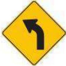
Estas señales se deben instalar para advertir a los usuarios sobre la proximidad de una curva a la izquierda, cuya velocidad de diseño es menor que la velocidad máxima permitida o de operación del resto de la vía. También se deben usar cuando la velocidad de diseño es igual a la velocidad máxima permitida o de operación de la vía, pero existen limitaciones de visibilidad u otras complicaciones operacionales.
