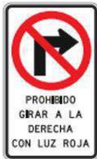
Esta señal se emplea para indicar a los conductores que acceden a una intersección controlada con semáforos, que no está permitido el giro hacia la derecha con luz roja, Solo se debe instalar previo estudio técnico realizado por la autoridad local competente, que demuestre que dicho giro a la derecha si constituye riesgo de accidentes.
