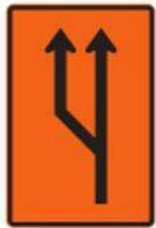
**SIO – 15 Generación de carril izquierdo en una calzada unidireccional de un carril**
