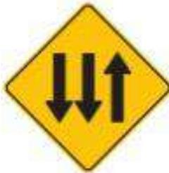
Esta señal se emplea para advertir a los usuarios la proximidad a un sector de la vía que contiene tres carriles, de los cuales uno será por la derecha, en el sentido en que se observa la señal y los otros dos, en el sentido opuesto (en contraflujo). Debe ser complementada con la señal reglamentaria SR-13 – TRES CARRILES (dos en contraflujo). Antes de finalizar el sector de tres carriles, debe tenerse la precaución de colocarse la señal SP-39 – CIRCULACIÓN EN DOS SENTIDOS.
