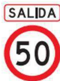
En los carriles de salida de una vía de alta velocidad, se puede colocar una señal de VELOCIDAD MÁXIMA, con una placa que indique que dicho límite se aplica solamente al ramal de salida; el tamaño de las letras y números se fijarán según la velocidad máxima permitida en el tramo de la vía principal.
