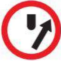
Estas señales se usan para indicar a los conductores que deben continuar circulando por el lado derecho de la calzada.
