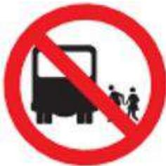
Esta señal se emplea para notificar a los conductores de vehículos de servicio público o de cualquier otro tipo, que les está prohibido detener el automotor para el ascenso o descenso de pasajeros en los sitios aledaños a la señal. Se debe usar especialmente en el ingreso y salida de puentes, túneles, y cualesquiera otros sitios en donde resulte riesgosa la detención de un vehículo.
