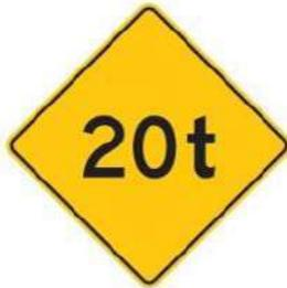
Esta señal se debe utilizar para advertir que más adelante en la vía, existe un puente, viaducto u otra estructura vial en la que sólo se permite la circulación de vehículos cuyo peso bruto total no exceda de las toneladas indicadas en la señal. La señal debe indicar el peso total máximo permitido en toneladas y ser instalada de acuerdo a lo señalado en el numeral 2.3.3. Ubicación de las Señales Preventivas.
